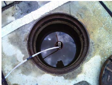
บ่อสังเกตการณ์น้ำใต้ดินท้ายน้ำ ของโรงงานผลิตสาร โอลิฟินส์ โรงที่ 1/2
